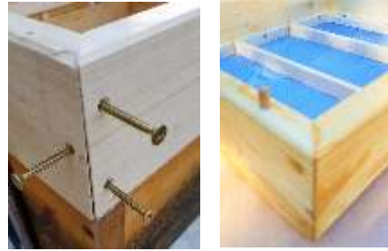
Abbildung 2: Verschraubung des Rahmens vorher und nach dem Verspachteln der Schraubenlöcher
